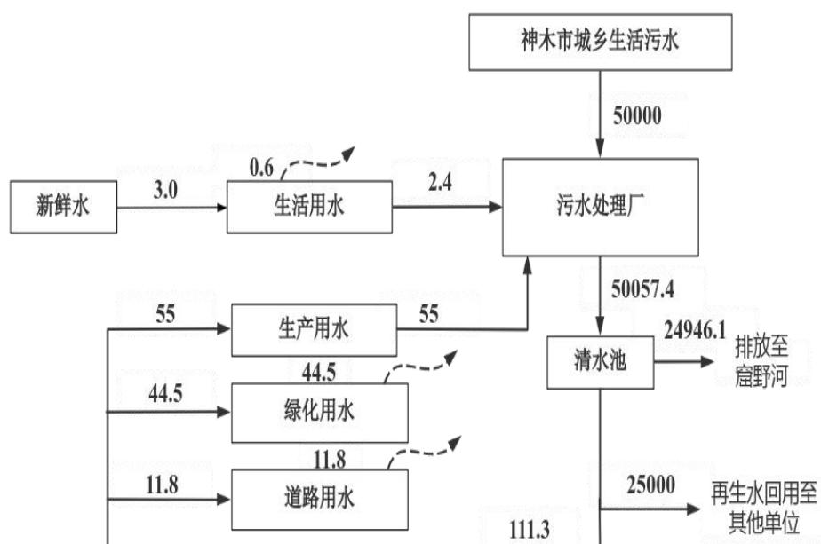
图 2-6 项目水平衡图 (单位:  $\text{m}^3/\text{d}$ )
