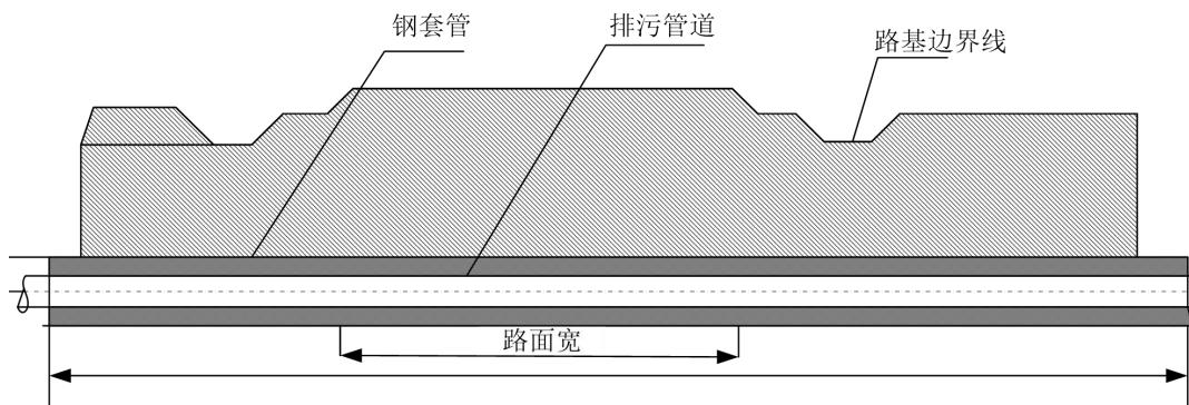
图 2-8 道路穿越施工方式断面示意图
