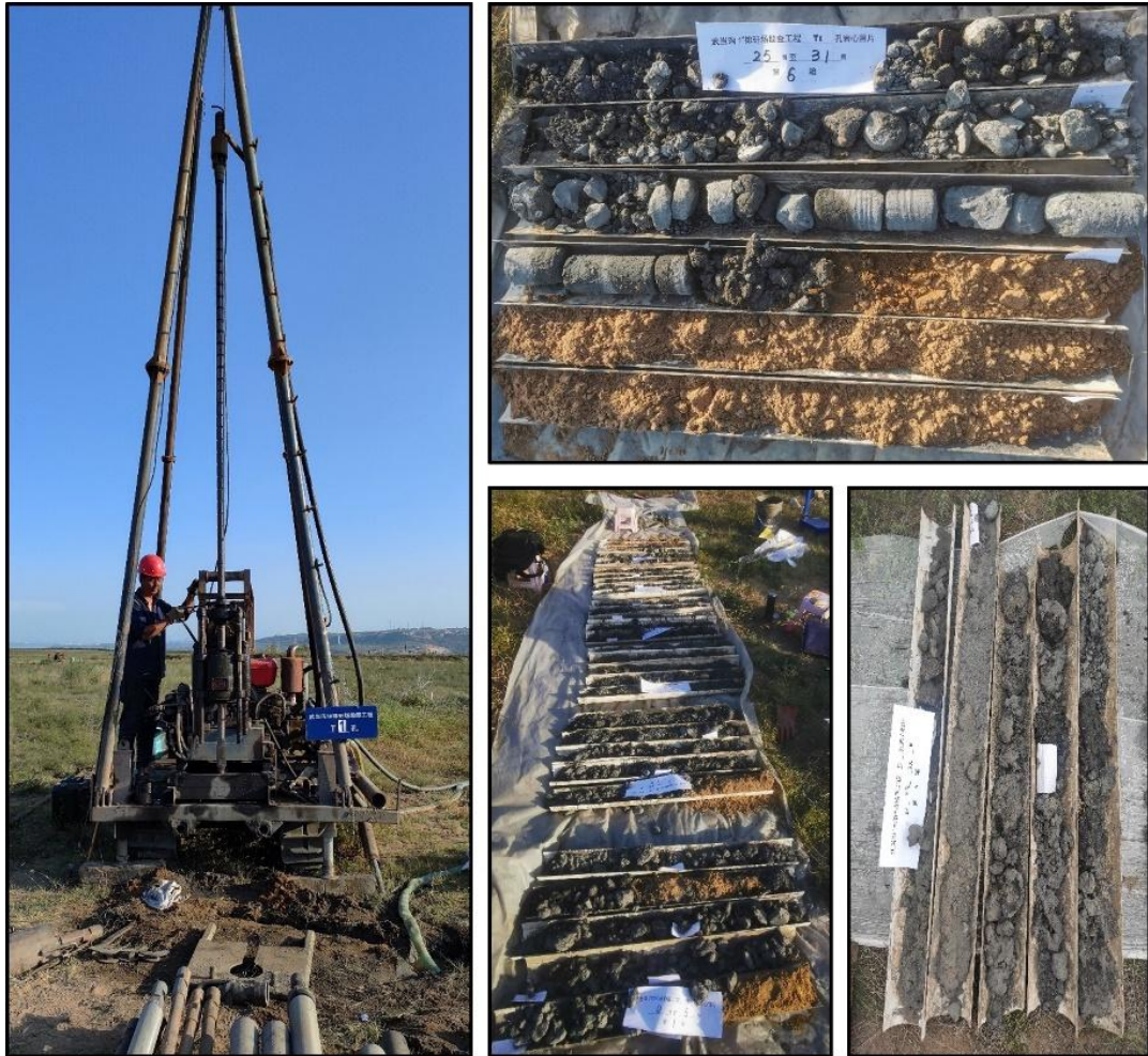
图 2-2 大柳塔武当沟 1#排矸场钻孔勘探样点设置
