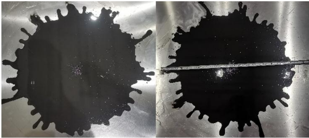
武当沟1#排矸场煤矸石基机制砂流动效果与流动度65cm
