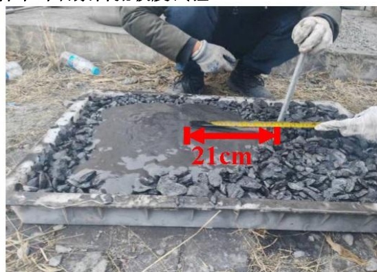
图 2-22 矽石堆有水条件下矽石浆自流坡度试验
