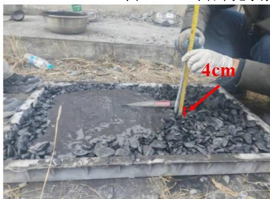
图 2-22 矽石堆有水条件下矽石浆自流坡度试验
