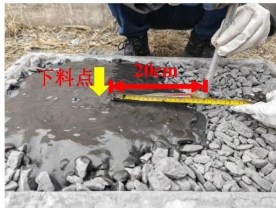
图 2-21 矽石堆无水条件下矽石浆自流坡度试验
