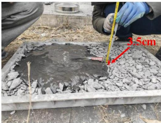
图 2-21 矽石堆无水条件下矽石浆自流坡度试验
