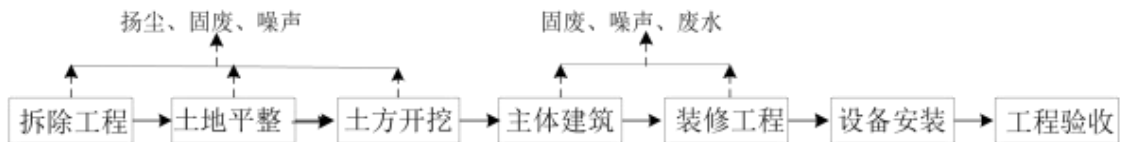
图3 施工期流程及产污环节图
