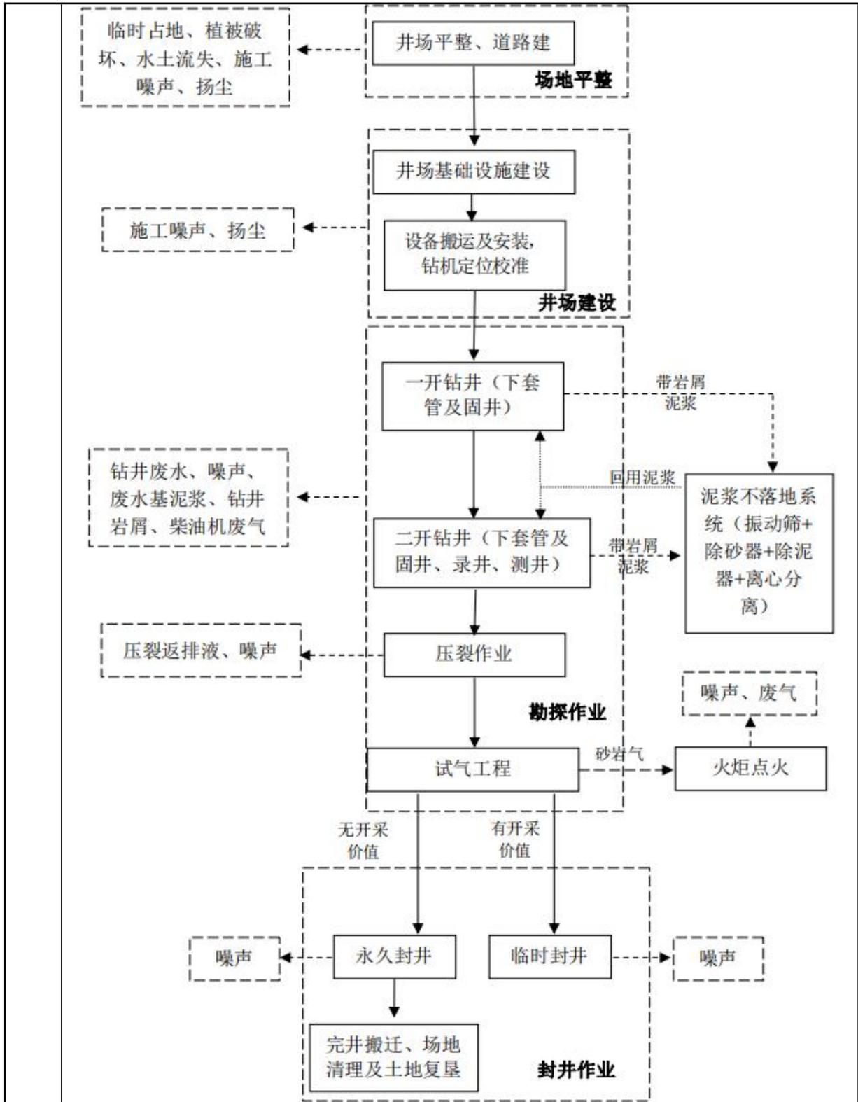
图2-5 项目主要工艺流程及产污环节
