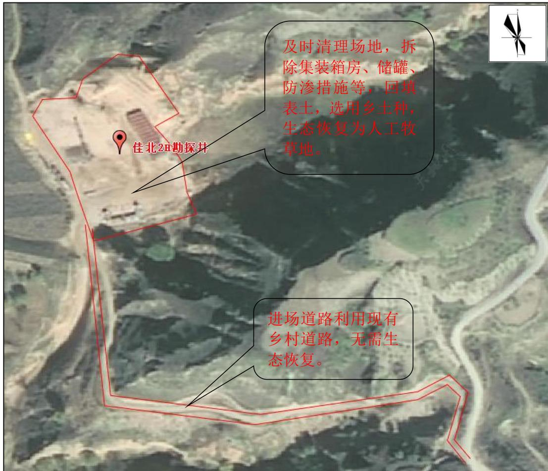
图 5-1 生态环境保护措施平面布置示意
