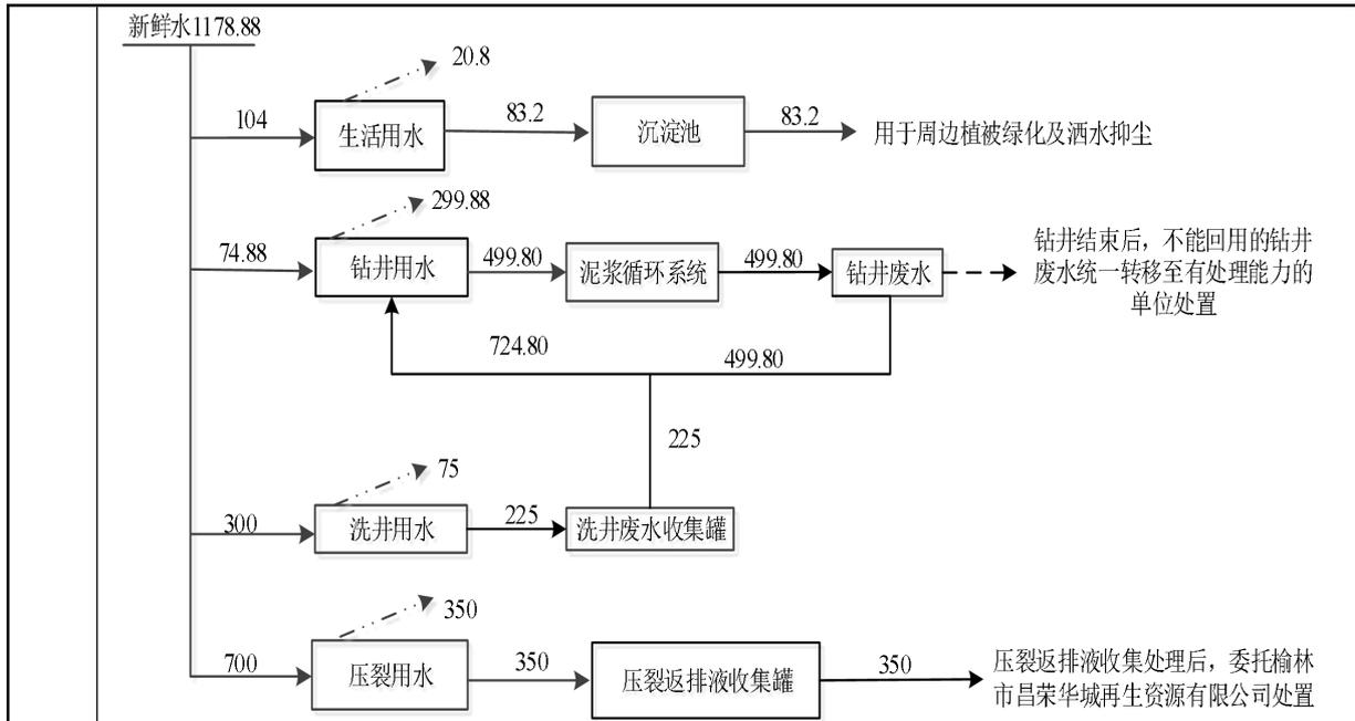
图2-1 项目水平衡图 单位m<sup>3</sup>
