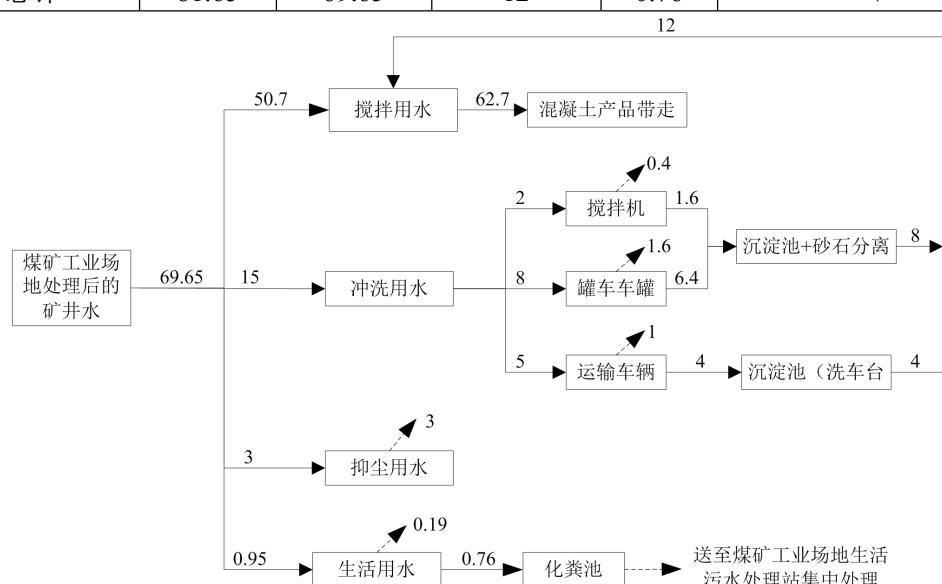
图 2-1 项目水平衡图 (单位： $\text{m}^3/\text{d}$ )
