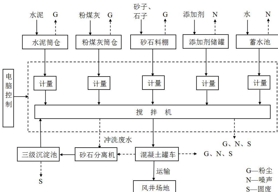
图 2-3 项目生产工艺及产污环节图
