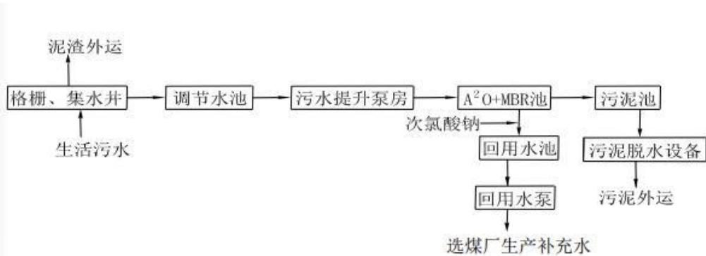
图 4-1 矿井工业场地生活污水处理站工艺流程图
