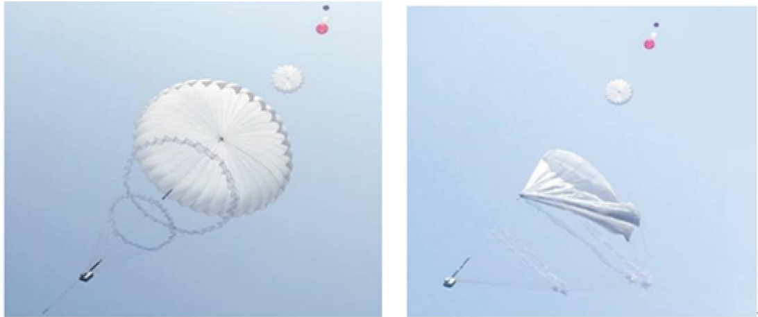
图2-6 做功伞打开做功/闭合回收状态示意图
