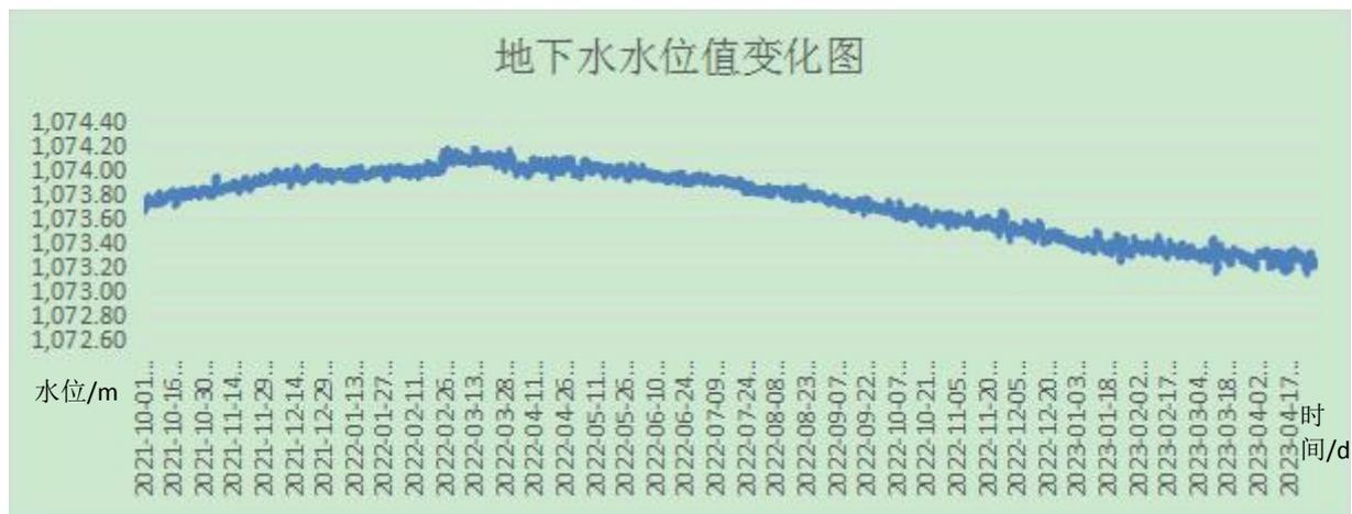
因监控井监测的是 $4^{-2\pm}$ 煤层，监控井位于悖牛川的西侧，距离 $4^{-2\pm}$ 煤层采空区东侧332米，经预测 $4^{-2\pm}$ 煤层开采边界外水位下降影响半径223.63m， $4^{-2\pm}$ 煤层开采还没有影响到监控井周围的水位，通过对监控井水位进行长期监测，根据目前监测记录可知，水位波动幅度较小，开采过程对地下水水位影响较小。
