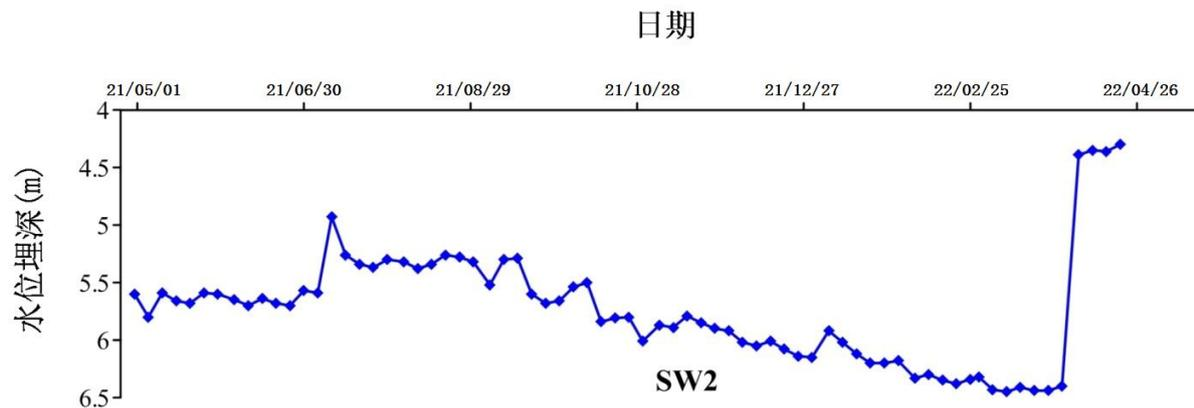
图4.1-8 孙家盆地下水位长观井水位变化图
