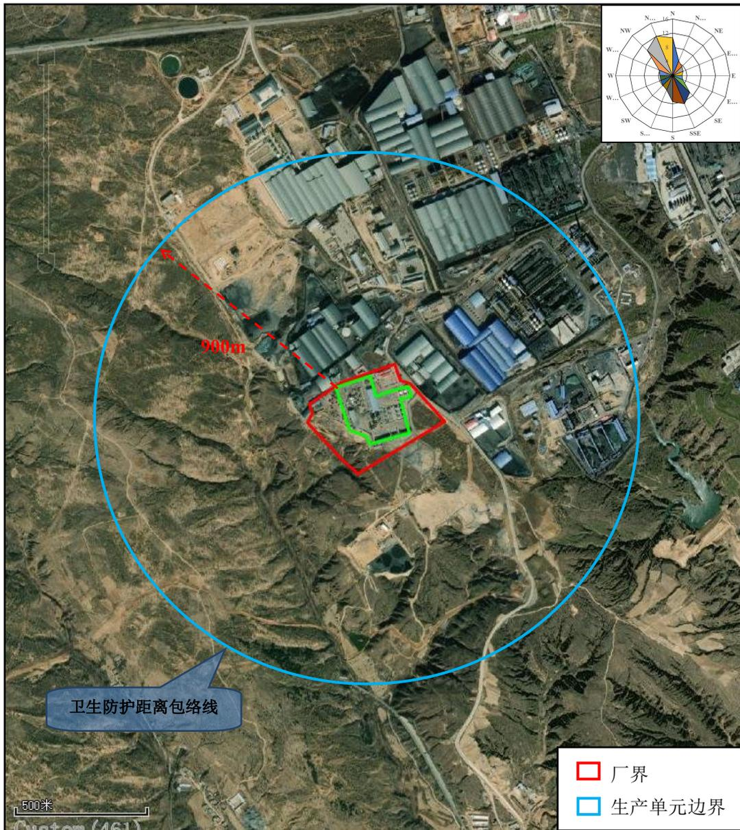
图 5.2.1-20 卫生防护距离包络线图
