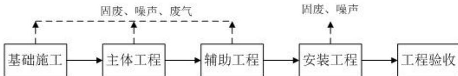
图 2 施工期生产工艺流程及产污环节图
