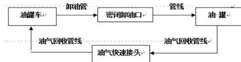
图4 油品卸车工艺流程图
