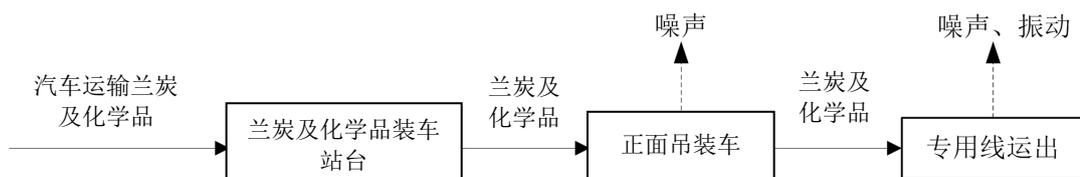
图 2-4 兰炭装车系统工艺流程及产污环节图
