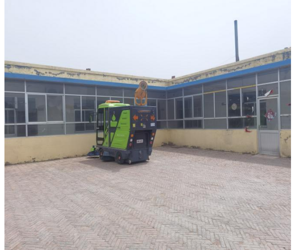
厂区雾炮降尘装置
