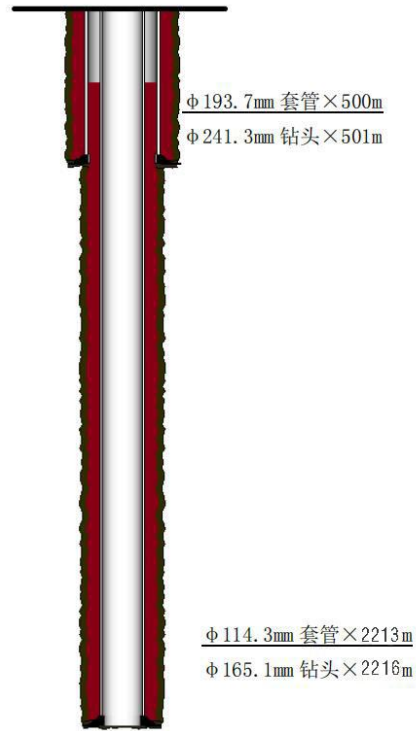
图 2-4 井身结构示意图
