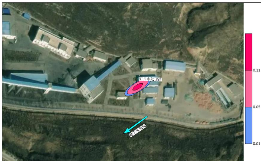
图 6.6-5 矿井水泄漏后 100d 石油类对潜水含水层的影响范围
