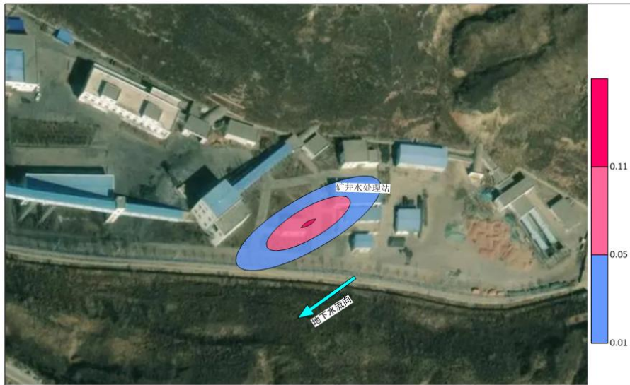
图 6.6-6 矿井水泄漏后 1000d 石油类对潜水含水层的影响范围
